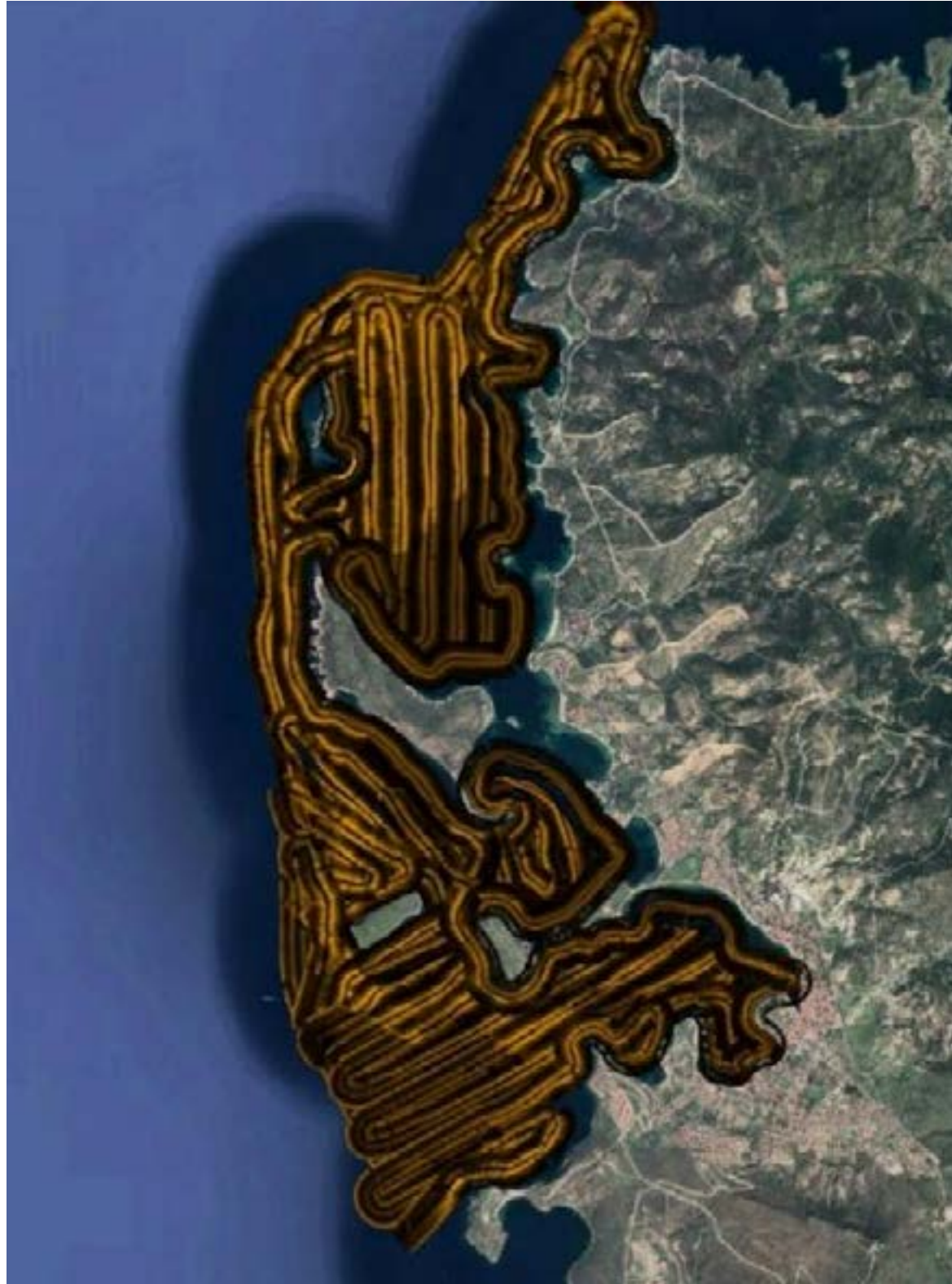
Şekil 25 Bottom track ve slant range düzeltmeleri sonrası YTS mozaik haritası
