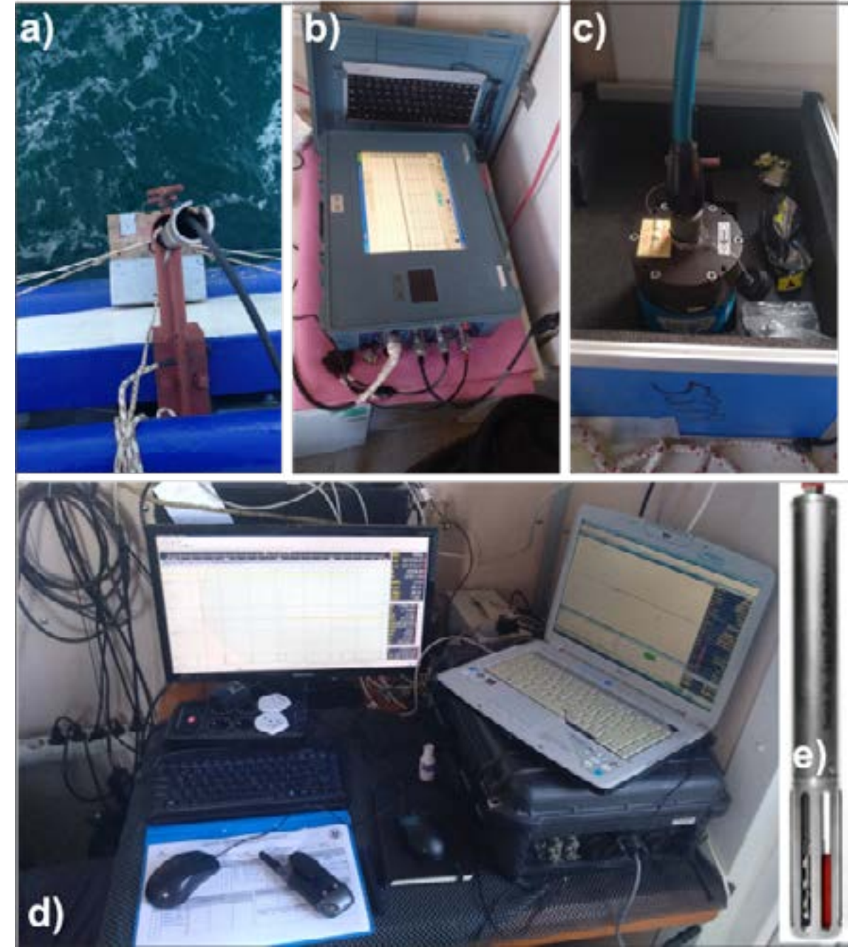
Şekil 2 Veri toplama bileşenleri a) Tek Işınlı Echo Sounder Transduser, b) TIB sistem birimi, c) TSS hareket sensörü, d) NAVIPAC navigasyon sistemi (sol), Hydro Pro veri toplama sistemi (sağ), e) CTD Probu
