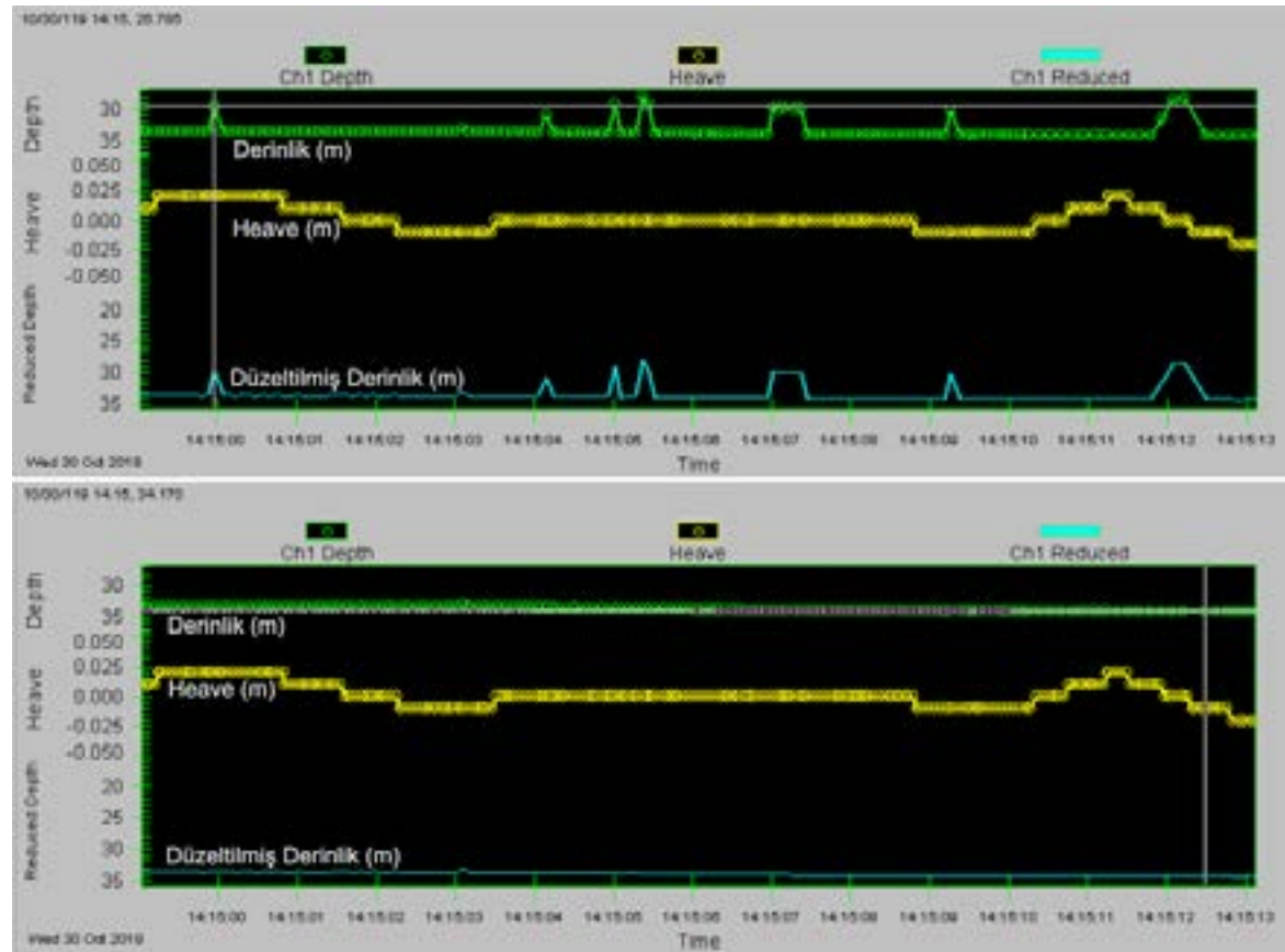
Şekil 23 fDK046 hattında meydana gelen saçılmaların bazılarının yakınlaştırılmış görüntüsü, heave değerleri ve düzeltilmiş derinlik değerleri
