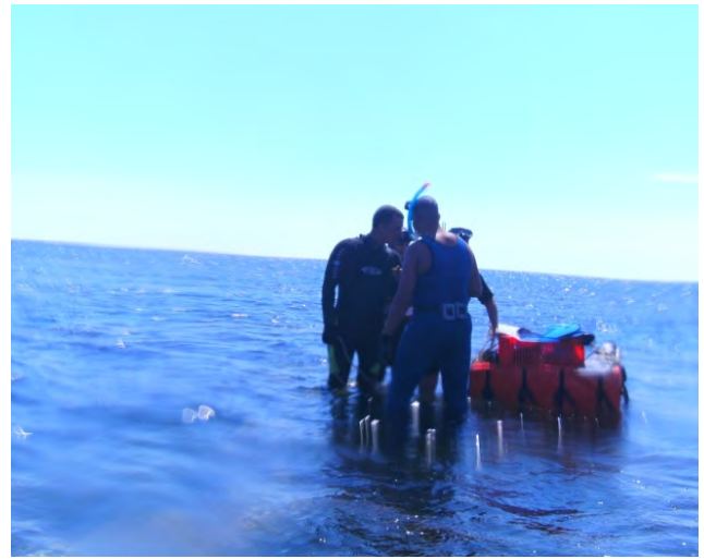
Figure 3 : Relevé du contour des formations récifales à la nage (photo de gauche) ou à la marche photo de droite) ; le radeau tracté supporte les GPS
