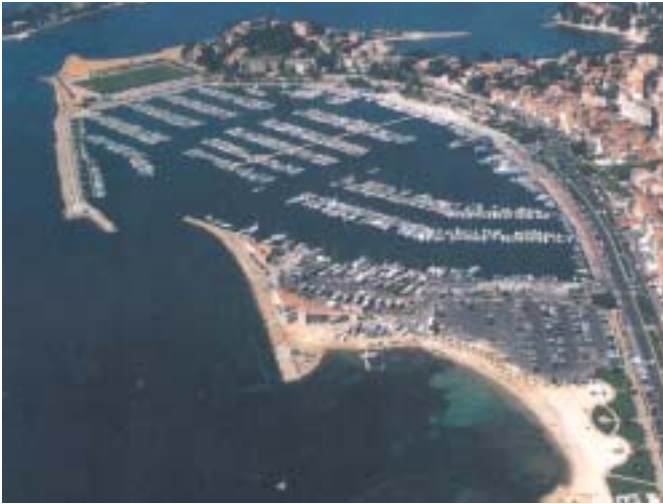
Fig. 56. Le port de Bandol (Var, France). Les 2 terre-pleins (en haut et en bas) ont été gagnés sur la mer (réclamations). Celui du bas a recouvert l'un des derniers récifs-barrière de Posidonia oceanica de Méditerranée Nord-Occidentale. Photo Anonyme.
