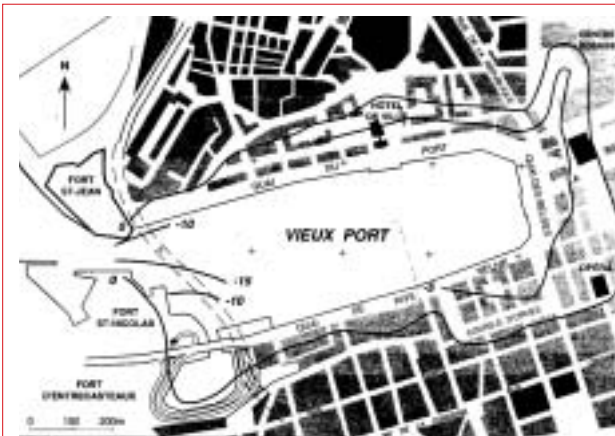
Fig. 54. Extension du Lacydon (le nom grec de la baie) de Marseille (France) (trait plein extérieur) et isobathes (traits pleins intérieurs) vers 600 ans avant J.C. comparées avec l'extension du Vieux-Port et l'urbanisation actuelles. D'après Millet et al. (2000).
