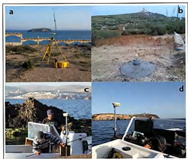
Figure A1-1 : a) station de référence (ST1) à terre en face de l'île ; b) Matérialisation de la station de référence (ST3) ; c) calibration de l'échosondeur ; d) acquisition des données en mer
