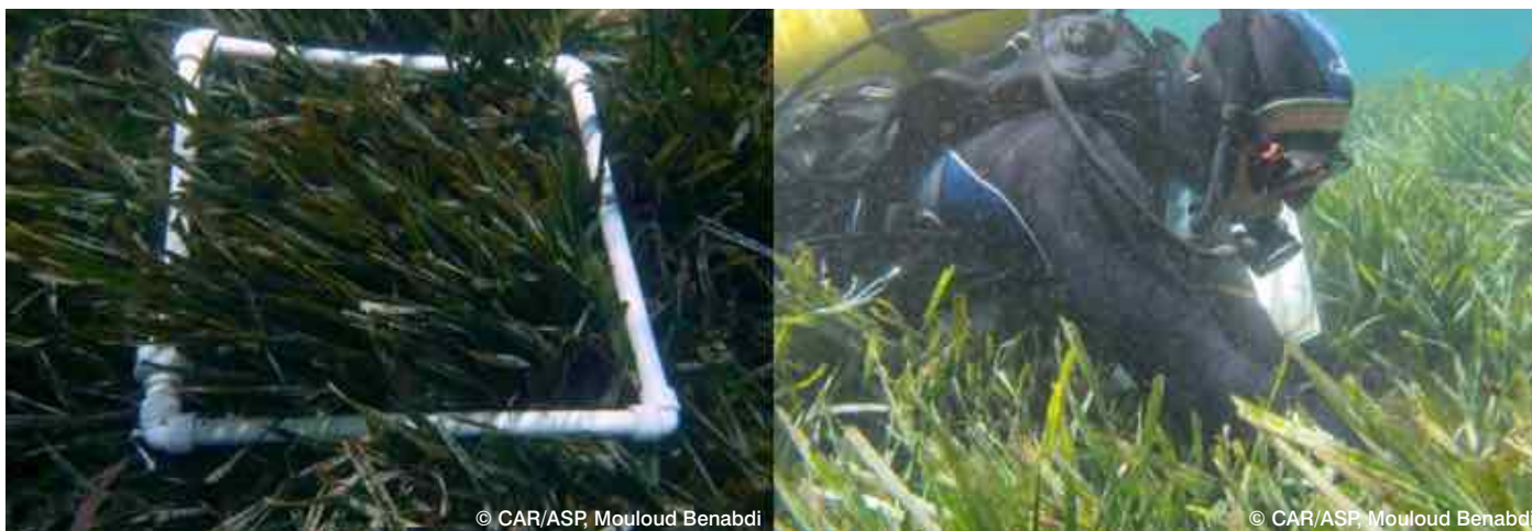
Figure 5-4. Quadrat en PVC plombé utilisé pour estimation de la densité
