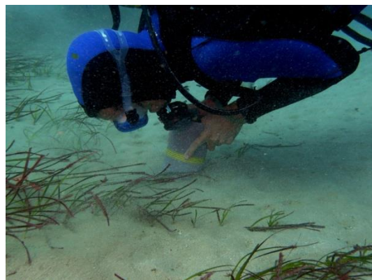
Figure 9 : Prélèvement des échantillons à l'aide d'un carottier en PVC.
