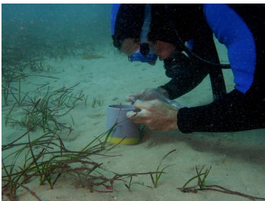
Figure 9 : Prélèvement des échantillons à l'aide d'un carottier en PVC.
